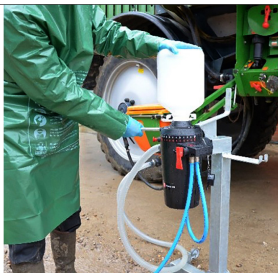
Le bidon de produit positionné sur le connecteur du dispositif easyconnect.
