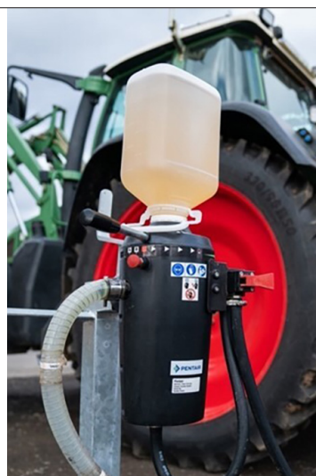
Le bidon de produit positionné sur le connecteur du dispositif easyconnect.
